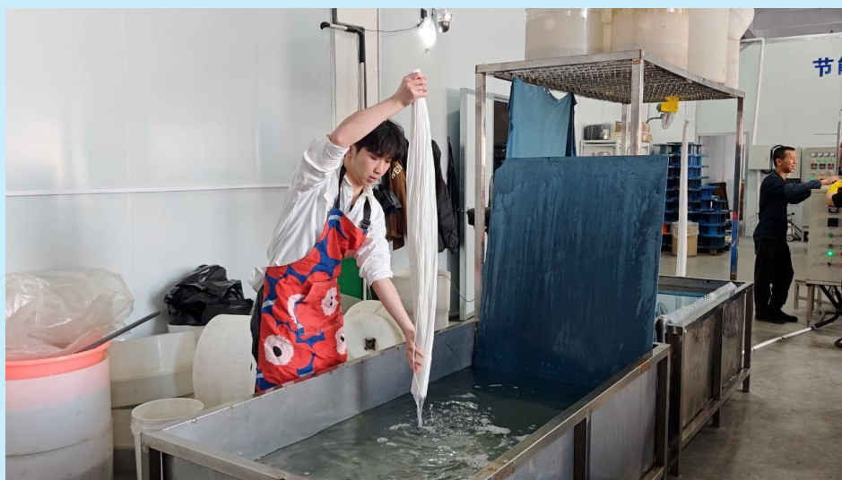
图 2-8-1 曹万基在工厂制作 MBR 膜
